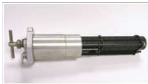
Первый фильтр МФМ-25 для очистки авиационных масел, освоенный в 1944-1945гг.
